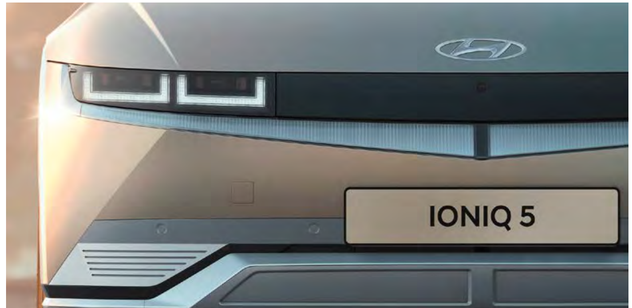
Unike LED-hovedlykter med 256 parametriske piksler.
