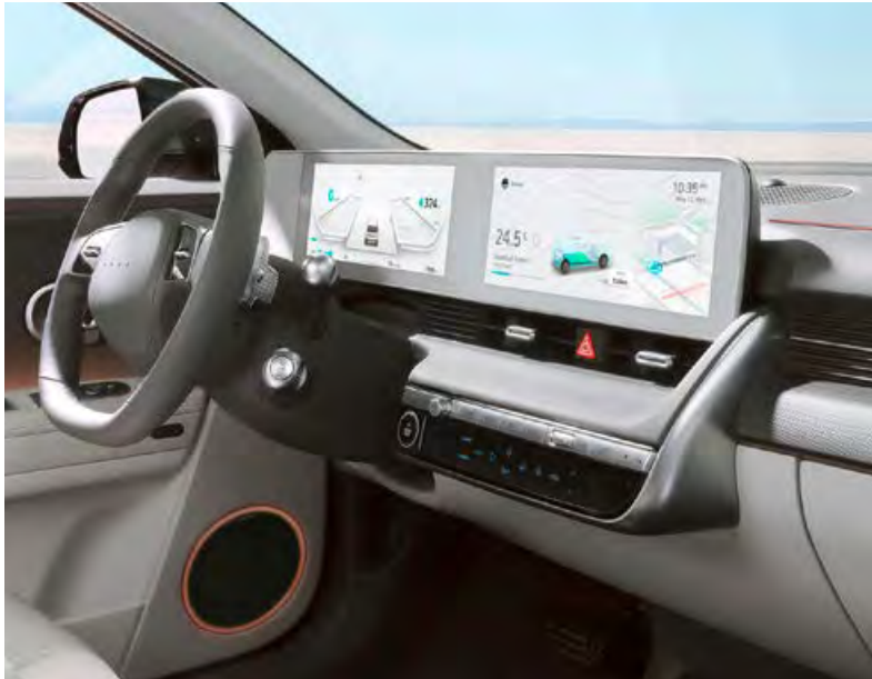
Infotainmentskjermen på 12,3 tommer og det digitale instrumentdisplayet på 12,3 tommer gir enkel tilgang til alle kjøre-, sikkerhets- og infotainmentfunksjoner.
